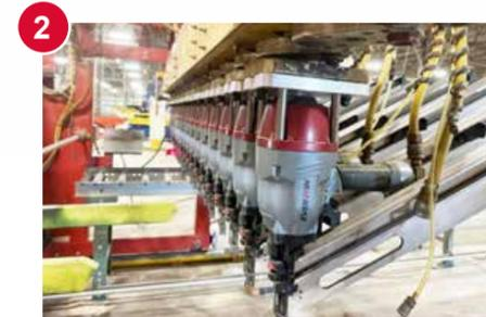
Automatización: FSN3490 en puente de panel de pared
